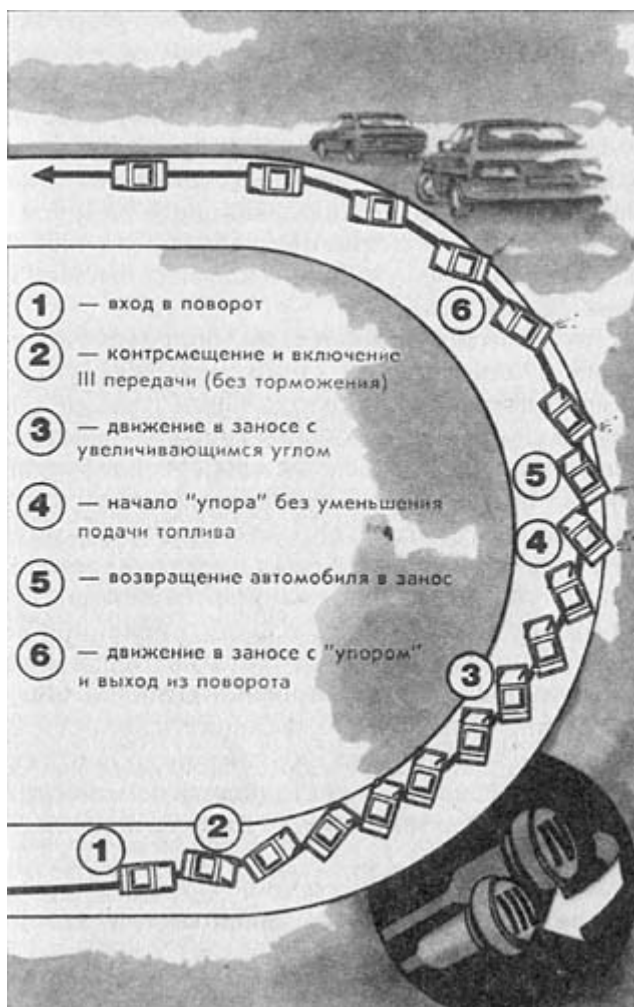
Рис. 21. Прохождение "ипподромного" поворота в заносе с контактным торможением
