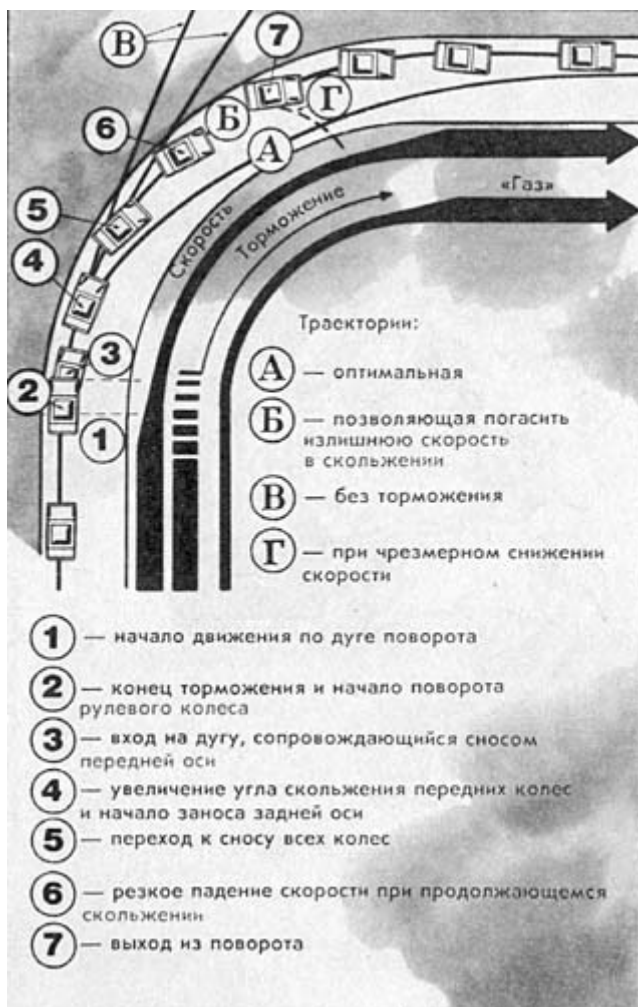
Рис. 10. Снижение скорости при прохождении поворота силовым скольжением
